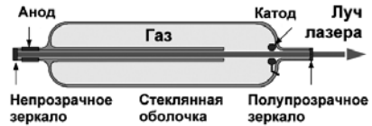
Рис. 9. Схема газового лазера
